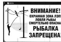
**!** Забрасывать блесны и другие снасти вблизи ЛЭП опасно — мокрая леска — хороший проводник тока. Зацепившись снастью за провод, можно попасть под напряжение.
